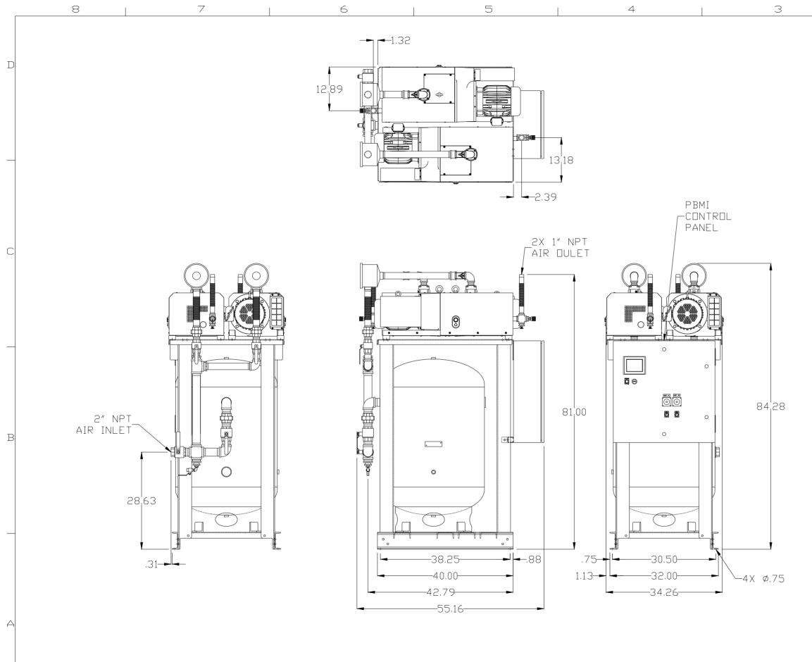
NOTE: A MINIMUM OF 24" CLEARANCE IS RECOMMENDED AROUND THE ENTIRE UNIT.
