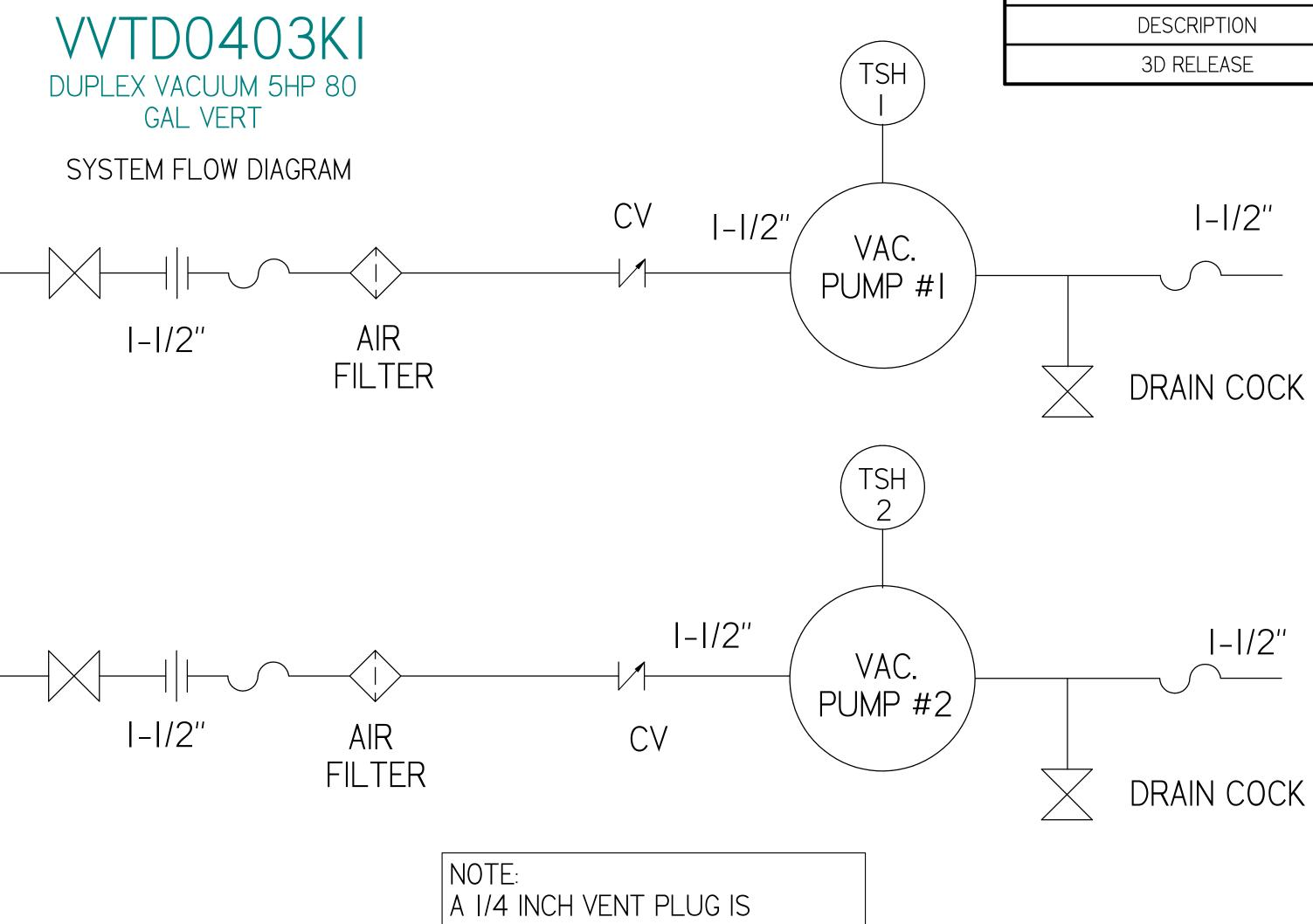
A I/4 INCH VENT PLUG IS LOCATED IN THE FILTER HOUSING
