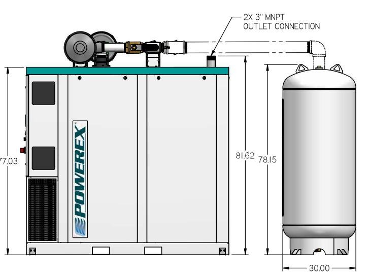
NOTES: I) APPROX SYSTEM WEIGHT: 6297 LB 2) FINAL SYSTEM DIMENSIONS DEPENDENT UPON INSTALLATION CONFIGURATION. MAINTENANCE CLEARANCE MUST BE MAINTAINED IN INSTALLATION CONFIGURATION.
